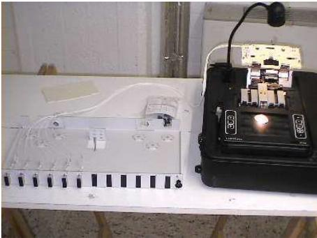
Die werkzeuglos entnehmbare Schublade ist zum Spleißen vorbereitet. Die Kupplungen sind montiert, die Faserpigtails abgesetzt, nummeriert und in der Spleißkassette abgelegt (ab Werk)
